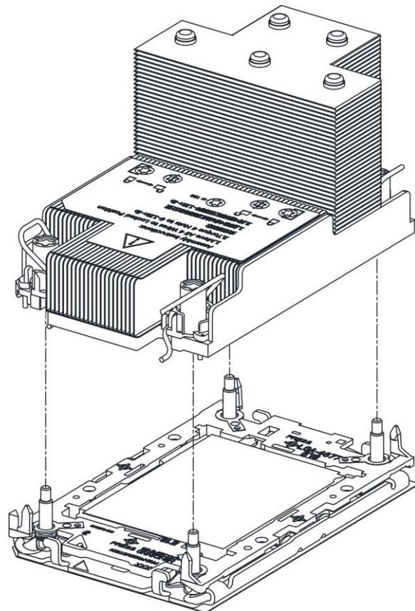
3. 按下散热器上的紧固锁扣，使之与处理器底座的卡钩卡住。
