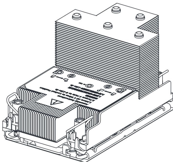
4. 使用 T30 梅花螺丝刀拧紧固定散热器的螺钉。
