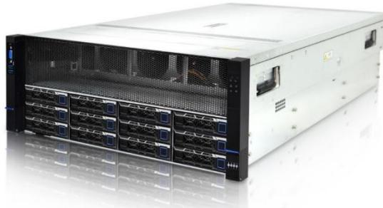
R4226-8G 是中科云达自研的一款全国产机架式 4U-8GPU 人工智能 AI 服务器，支持两颗鲲鹏 920-Max/920-Smart 模组，支持 8/10 个双宽全尺寸 GPU 卡，或 12 个单宽全尺寸 GPU 卡，提供超 1TB 显存容量，支持基于昇腾 910/310 芯片的各类 GPU 卡，以及其他国产 GPU 卡，该产品适合大语言模型训练、模型微调高并发推理，大型知识库搭建、HPC、仿真渲染等应用场景。
